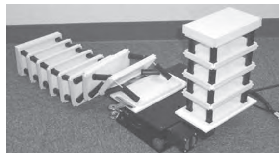
写真3 8階建て模型の倒壊
