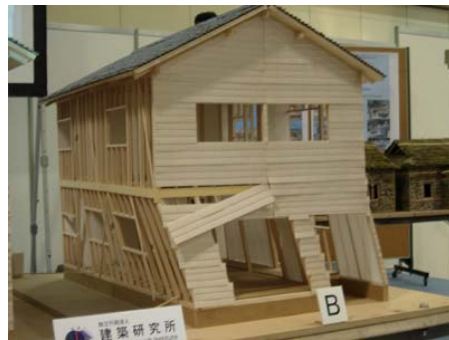
写真3 B棟残留変形
