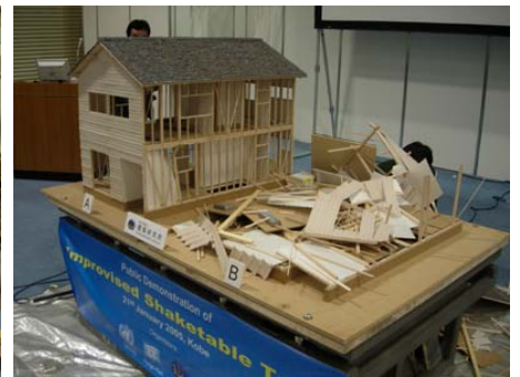
写真4 B棟倒壊状況
