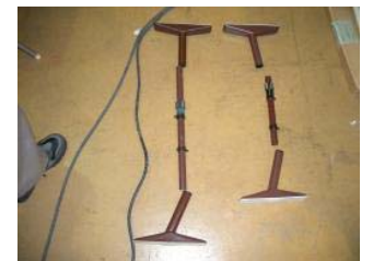
図1d 鋼製ポールの破損
