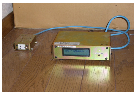
写真1 地震計の外観(左はセンサー部、右はコントロール・表示部)
