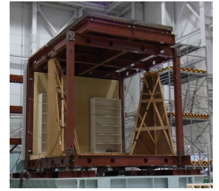
図 6 実大振動台実験外観
