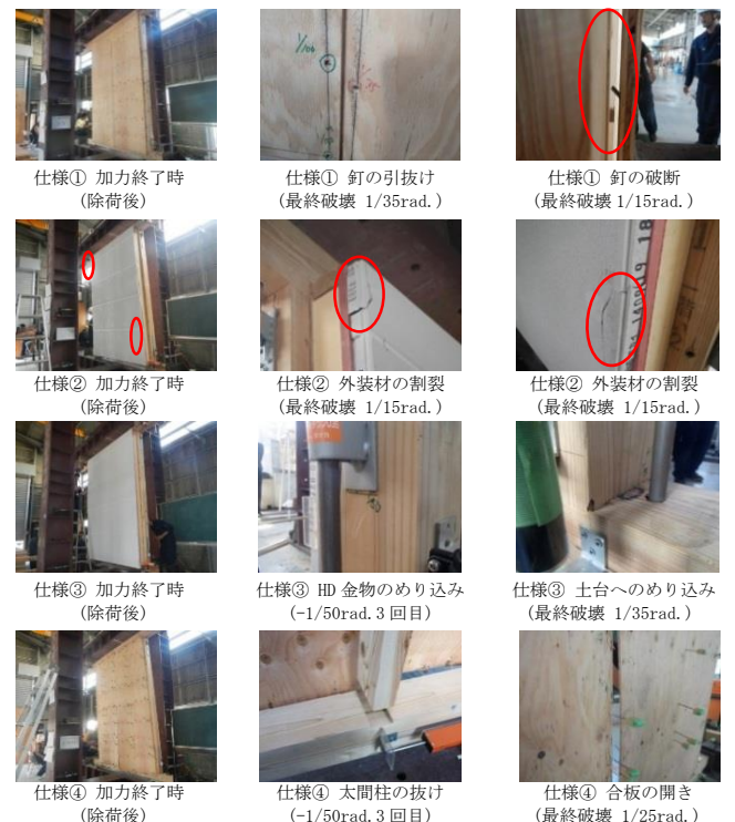
図2 損傷箇所の一例
