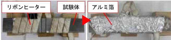
写真1 試験体の加熱状況
