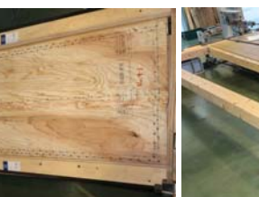
写真4 合板の面内せん断破壊(No.9,10)
