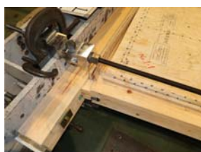
写真2 柱脚部の引き抜け (全て)
