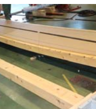
写真5 柱の曲げ(No.5)
