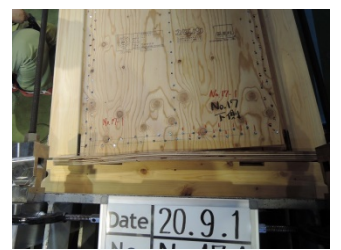
写真.4 面材の床面材へのめり込み(No.17)
