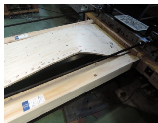
写真.3 面材の面外はらみ (No.15)
