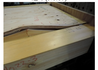
写真.8 受材の割裂、座屈 (No.22)
