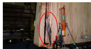
座屈による割裂破壊 (C12ES3-1)
