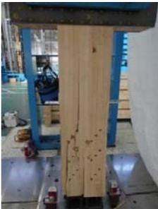
写真.1 ドリフトピン位置での割裂
