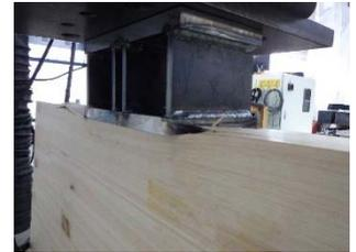
写真.4 箱形金物の梁へのめり込み
