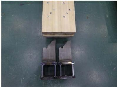
写真.2 ドリフトピン位置での金物破断（試験体 2, 6）
