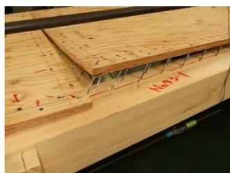
写真.1 釘の引抜け (例 No. 43)
