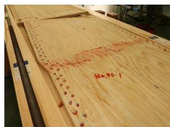
写真.2 面材の面内せん断破壊 (例 No. 45)
